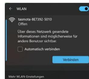
3. Nach erfolgreicher Verbindung mit dem WLAN Netz, kann im Browser die Tasmota Weboberfläche unter der Adresse: <http://192.168.4.1> geöffnet werden.
